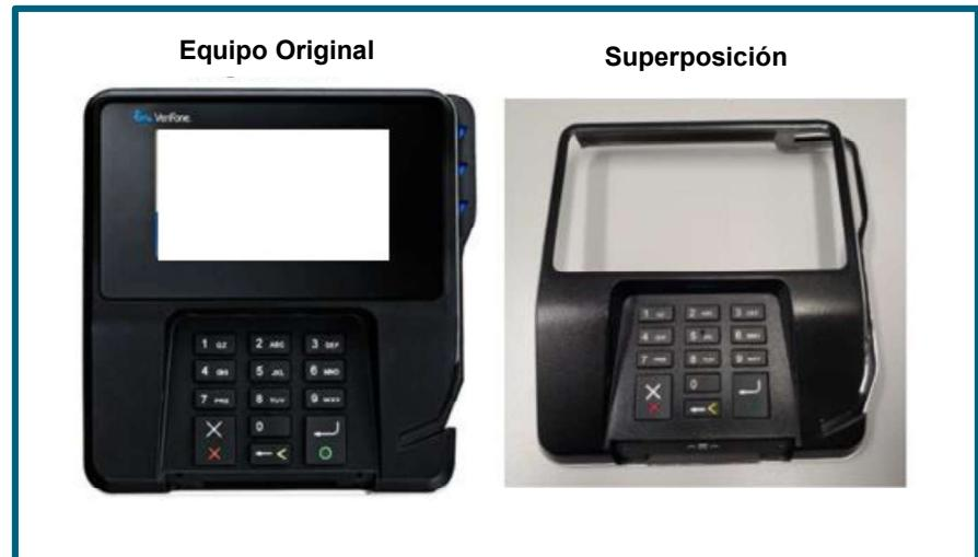
Las superposiciones de los dispositivos generalmente se colocan con cinta adhesiva de doble cara para adherirse a la máquina original. La capa protectora se puede quitar fácilmente levantando los bordes o las esquinas, esto permitirá que la capa se separe del dispositivo original.
